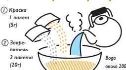
Положить краситель (5 г) и фиксирующий агент (20 г) в контейнер для растворения. Хорошо растворить в 200 мл теплой воды (40-60°C) до полного растворения красителя и фиксирующего порошка, без крупных зерен. Для красивого эффекта сделать 2 красящей жидкости для разных цветов.
